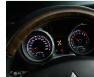
Compteurs et indicateurs rétro-éclairés et très contrastés avec tachymètre, repère de position 4WD et rhéostat 📷 23
