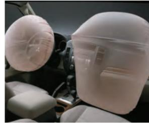
Airbags SRS avant (double étage) pour conducteur et passager avant 📷 03
