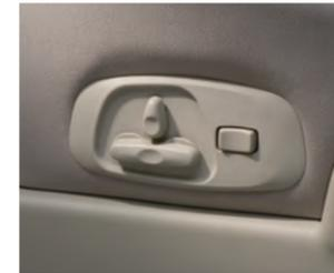
Siège conducteur à réglage électrique 📷 25
